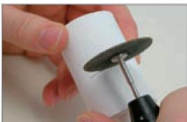
Отметьте длину плунжера на опоке и разрежьте паковочную массу вдоль отметки.
